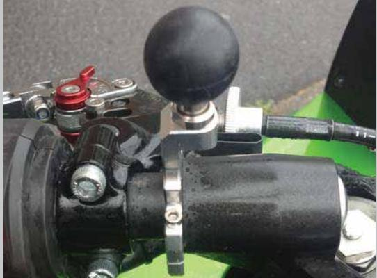
ナローマウントの取り付け位置は、必ず左右どちらかに寄せて取り付けて下さい。隙間がありますと、振動によるブレや位置調整した際の過度な力により破損する恐れがございます。
