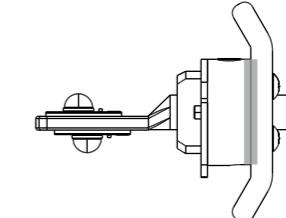
伝熱シリコングリスをフランジとヒートリボンプレートの間に一部に塗布し、ヒートリボン固定用ネジで固定します。
