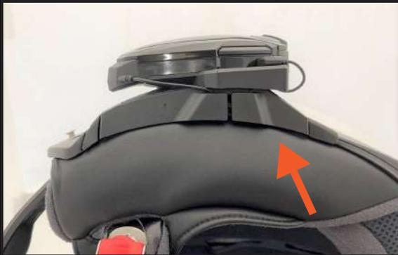
余った配線は、内装の隙間へ収納します。
