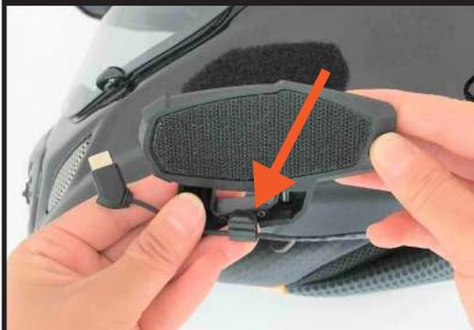
ベースプレートを貼り付けます。「スピーカー固定用ハーネスクリップ」を使用して、スピーカーの配線を留めておくとスムーズです。
