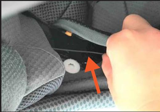
ヘルメット後方のスナップを外し、配線を帽体と内装のすき間に通します。
