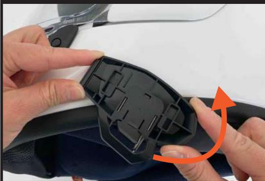
帽体の左側面に、ベースプレートを縦に差し込み、回転させるようにして奥に押し込みます。
