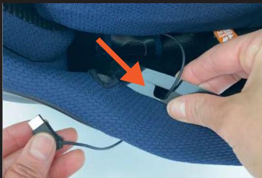
ネックパッドの穴へスピーカーのコンネクタを差し込み、外側へ出します。
