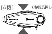
B+COM1ボタンとB+COM2ボタンを同時に2秒間長押しします。発信音が 출력され、[B機]→[C機]→[D機]の順で順番に接続します。
