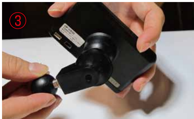
マウントシステムを取り付けます。
