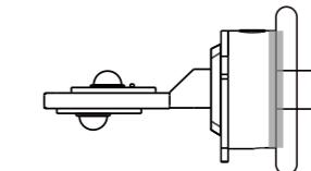
伝熱シリコングリスをフランジとヒートリボンプレートとの間に一部に塗布し、ヒートリボン固定用ネジで固定します。
