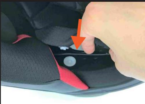
ヘルメット後方右側のスナップを外し、配線をスナップの内側に通します。
