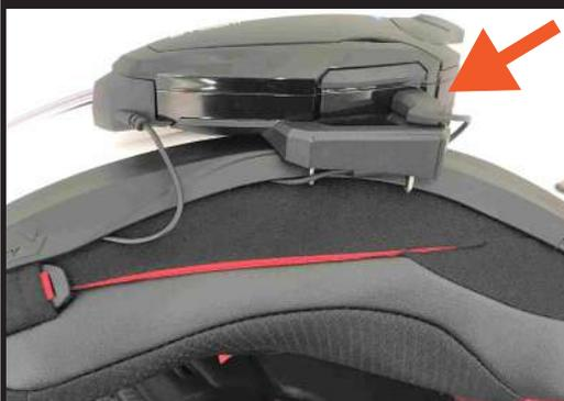
スピーカーコネクタは、本体後ろ側に配線が出る向きで接続します。
