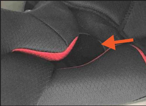
耳とスピーカーとの隙間が生じやすいため、「スピーカー調整パッド」を1枚貼り付けることをおすすめします。
