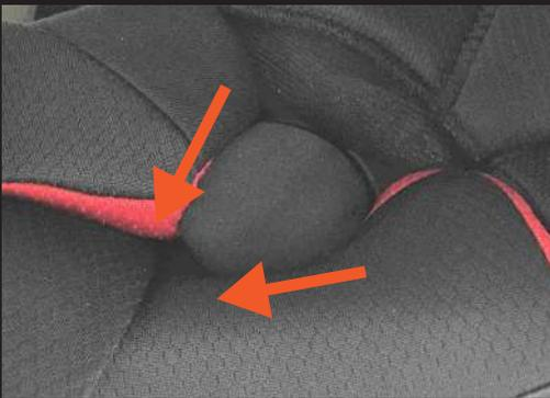
「スピーカー」を取り付けます。イヤーホールにそのまま合わせるのではなく、できる限りヘルメット前方、チンストラップの根本側へ寄せるのがコツです。
