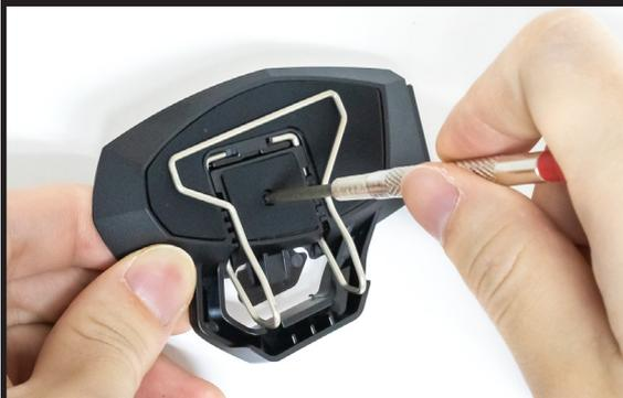
ワイヤークリップホルダーをガイドに沿って取付け、ネジを締めて固定します。
