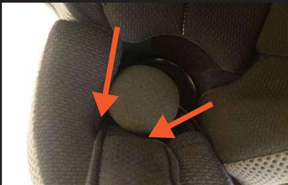
右側スピーカーを取り付けます。イヤールにそのまま合わせるのではなく、できる限りヘルメット前方、チンストラップの根本側へ寄せるのがコツです。
